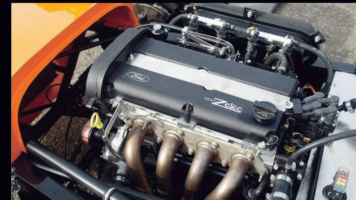
2,0-liter Zetec-motor van Ford, goet voor 170 pk. In een auto die 535 kg weegt!
