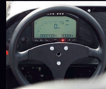
Geen snelheidsmeter in de Westfield, wel een laptimer met toerenteller.
